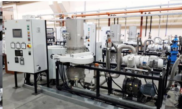
Вакуумные системы для вакуумных печей
